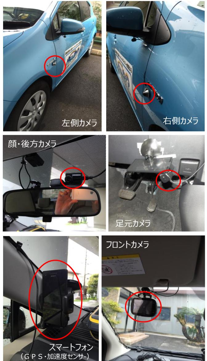
図-3 ドライブレコーダーとスマートフォンの設置
